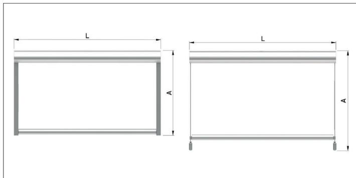
medición de sistema con guías
